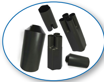
CTR y DTR Capuchones termorretráctiles Temperatura de trabajo -45° C a 105° C Derivaciones termorretráctiles 2, 3, 4 y 5 vías Temperatura de trabajo -45° C a 105° C
