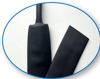
TRPF4X Tubos termorretráctiles Poliiolefina Pared fina / Sin adhesivo Contracción 4:1 Temperatura de trabajo -55° C a 125° C
