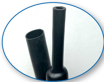
TRPM-S/A Tubos termorretráctiles Poliiolefina Pared media / Sin adhesivo Contracción 3:1 Temperatura de trabajo -45° C a 110° C
