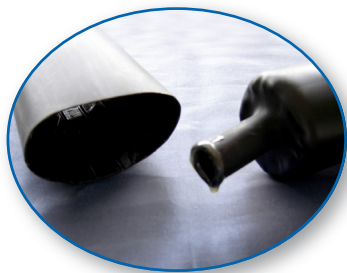
TRPM Tubos termorretráctiles Poliiolefina Pared media / Con adhesivo Contracción 3:1 Temperatura de trabajo -45° C a 110° C
