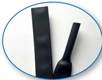
TRPF200°C Tubos termorretráctiles Poliiolefina Pared fina / Sin adhesivo Contracción 2:1 Temperatura de trabajo -55° C a 200° C
